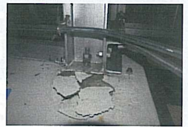
ボイラー基礎のコーン状破壊の被害事例
